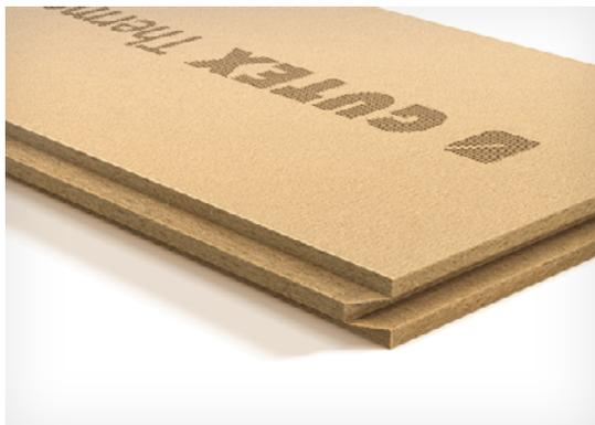
GUTEX Thermowall-gf è lo stabile pannello portaintonaco, particolarmente resistente alla compressione, con 40 i 60 mm di spessore – ideale per il rivestimento diretto su montanti in legno nel sistema ecologico termoisolante a cappotto Thermowall.
